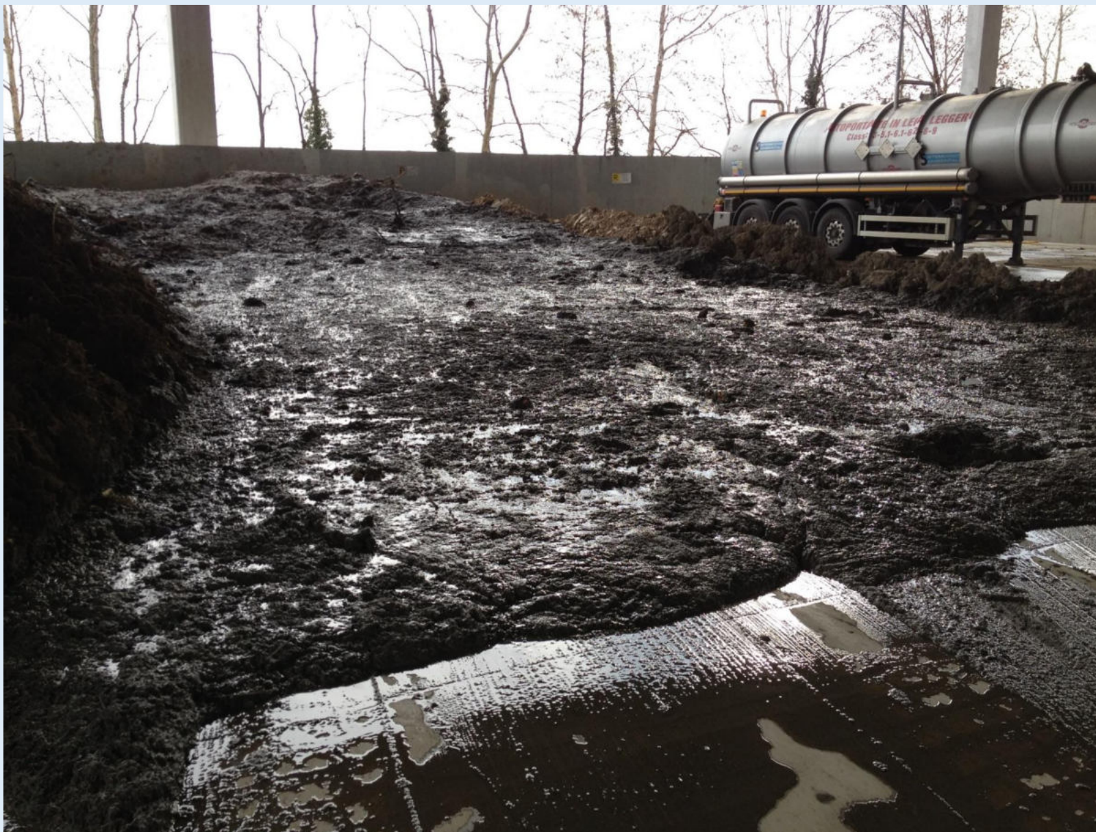
Scarico in impianto (stato fangoso non palabile)
