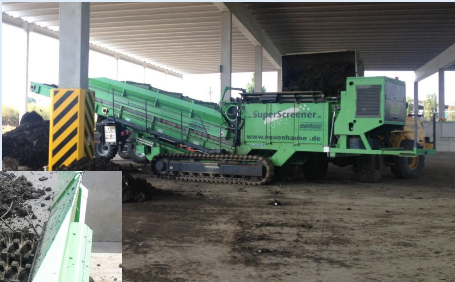
Vagliatura dimensionale primaria attuata con vaglio stellare
